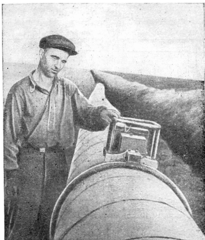
Рис. 29. Детектор для проверки качества изоляции труб.
